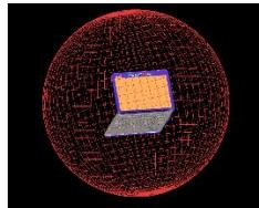
在开始仿真之前, 用户可以根据需要在模型中设置各种观察点(sensor)来收集数据, 用户可以决定 sensor 是点或是面或是一个空间区域的形态, 收集近场数据, 也可以设置 sensor 取得远场辐射场型等输出, sensor 设置完成之后, 建模工作也算是完成。
