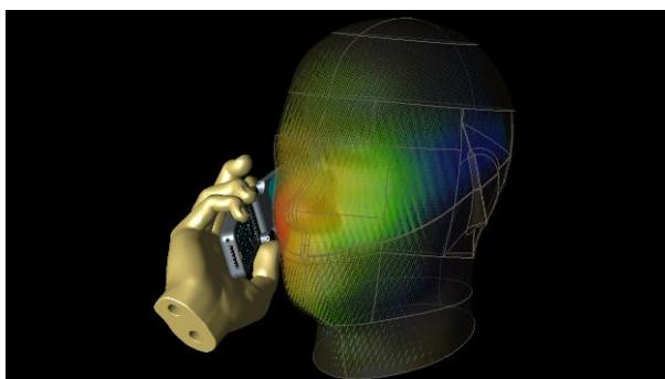
手机，平板，智慧型穿戴式装置，医疗设备等产品由于会和人体密切接触，需要确保安全无虞，因而会需要计算 SAR 来了解电磁辐射对人体的影响，XFDTD 支持不同标准的 SAR 计算，用户可以配合标准的 CTIA 头/手模型或是使用软件自带的高分辨率人体网格模型进行各种仿真。
