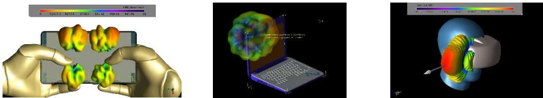
XFDTD 最经典，最常见的应用就是各种天线设计，尤其经常用于各种消费性电子产品的天线设计，上图从左到右为手机，笔记本以及 VR 头盔。现在的消费性电子产品尺寸越做越小，搭载的天线种类越来越多，结构和电路也越来越复杂紧凑，会需要更复杂精密的网格来描述，进入 5G 时代之后，毫米波频段的应用日增，频率提高也代表对网格的精度要求变高，时域的 FDTD 算法可以同时满足这双重对网格精度的高度要求，并有效地控制仿真所需的硬件资源增加的幅度。
