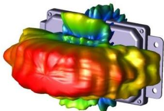
XFDTD 也经常用于各种雷达设计，如透地雷达，车用雷达或各种不同用途的雷达，左图为一个除天线以外，亦包含外壳以及 PCB 等所有零件完整的汽车雷达模型，汽车雷达经常在较高的工作频率使用，FDTD 算法可以在模型的精度和硬件资源消耗之间取得平衡。
