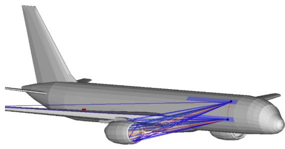
航空器，船舶，车辆等载具经常安装许多无线通讯设备或雷达，XGTD 可以对天线设置进行共址(Co-Site)分析，透过仿真分析耦合等现象，将传播路径视觉化，观察相应的多径效应的影响。左图为透过仿真实现波音 757 机身的数个通信模块之间耦合的情况并视觉化显示传播路径。
