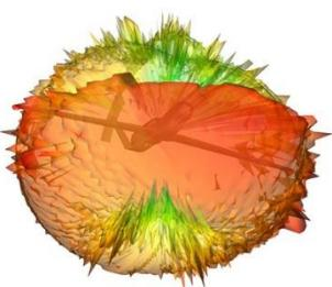
各种载具由于体积庞大产生阴影效应(shadowing effect), 影响设置于在上面的天线, 使性能和理想情况有差异, XGTD 能结合阴影效应以及多径效应的影响, 精确求出天线实际辐射场型, 并运用于 Wireless Insite 等下一阶段的仿真分析, 左图为安装在无人机首底部的天线实际辐射场型。
